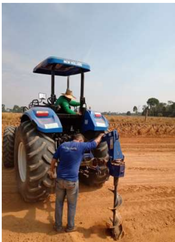
– Sondagem e Coleta de Amostra
