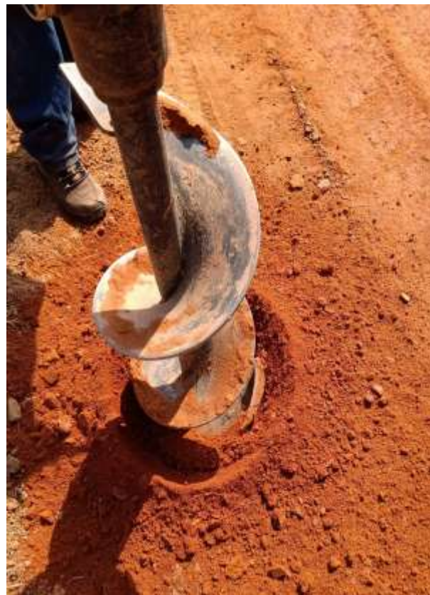
– Sondagem e Coleta de Amostra
