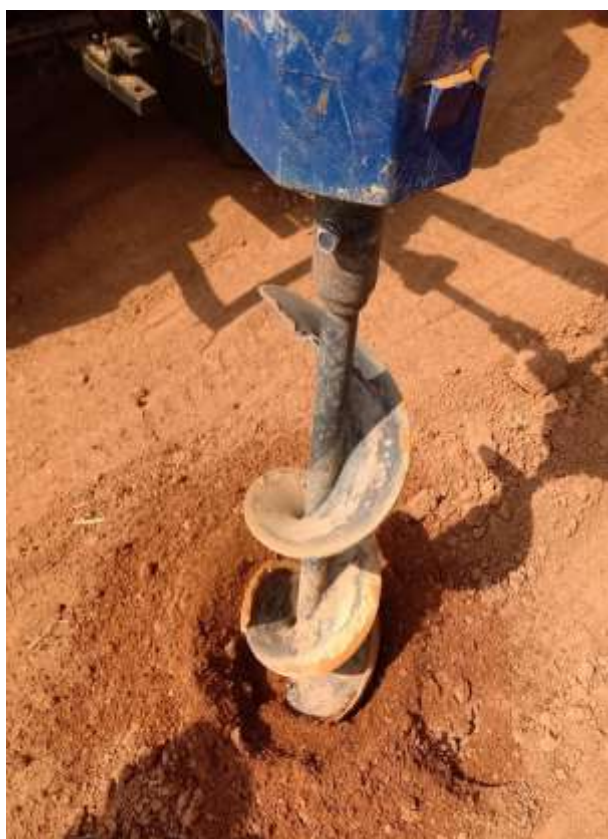
– Sondagem e Coleta de Amostra
