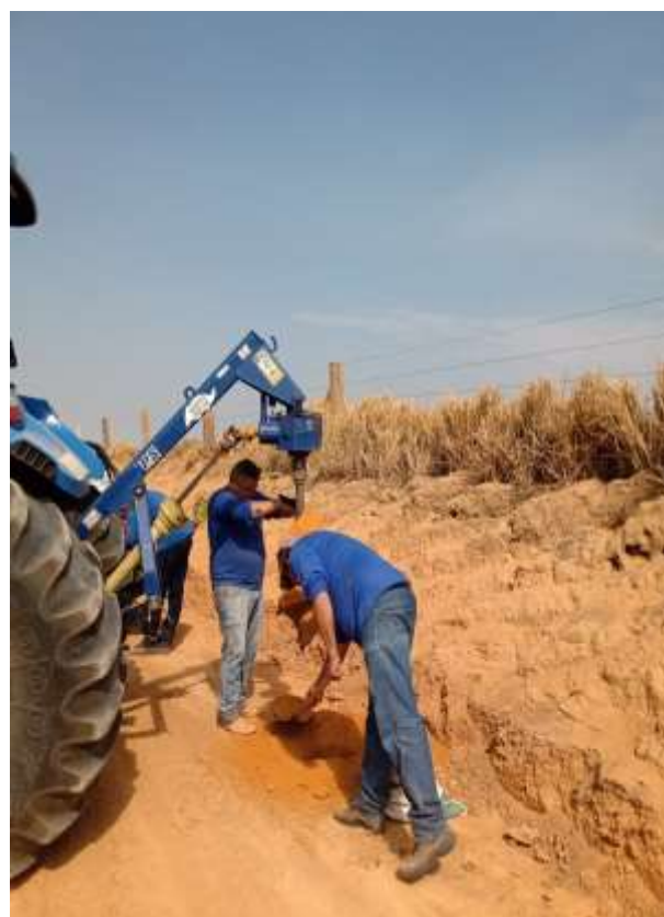
– Sondagem e Coleta de Amostra
