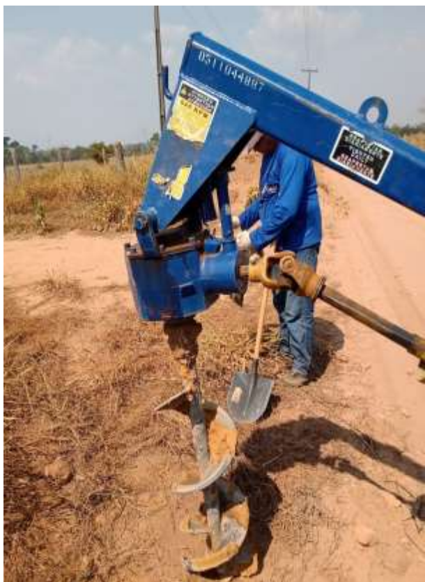
– Sondagem e Coleta de Amostra
