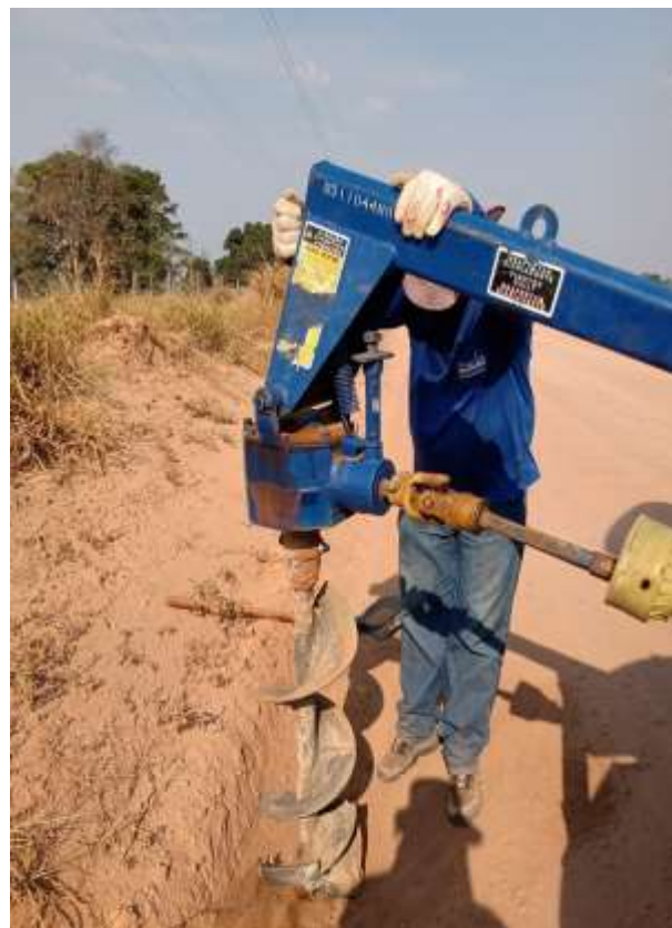
– Sondagem e Coleta de Amostra
