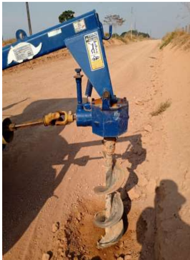
– Sondagem e Coleta de Amostra
