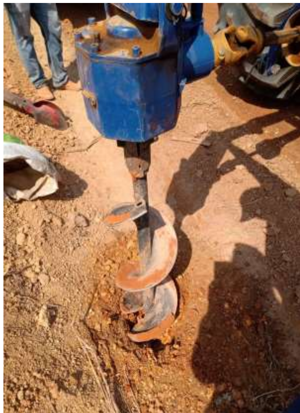
– Sondagem e Coleta de Amostra
