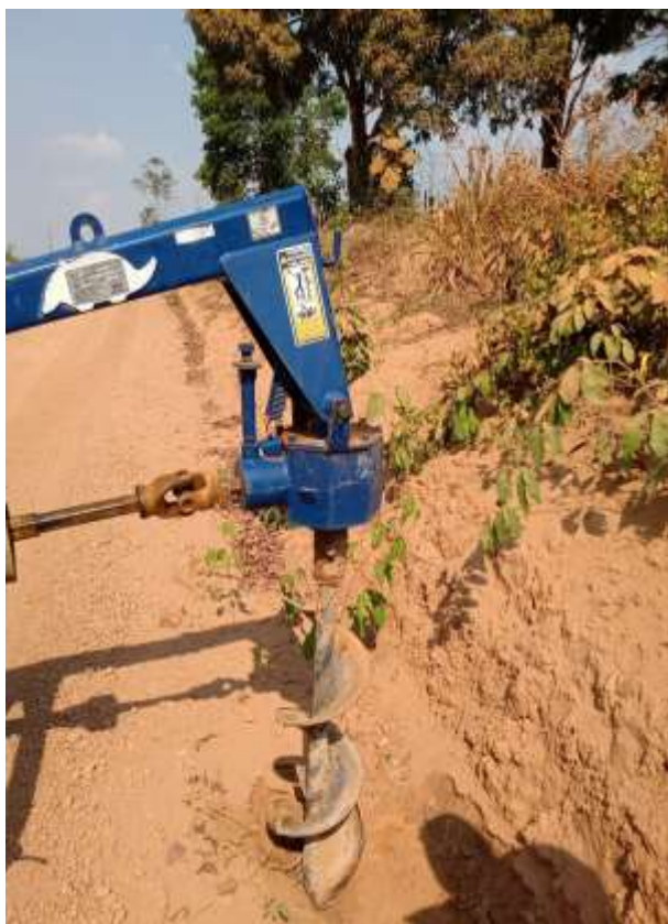
– Sondagem e Coleta de Amostra
