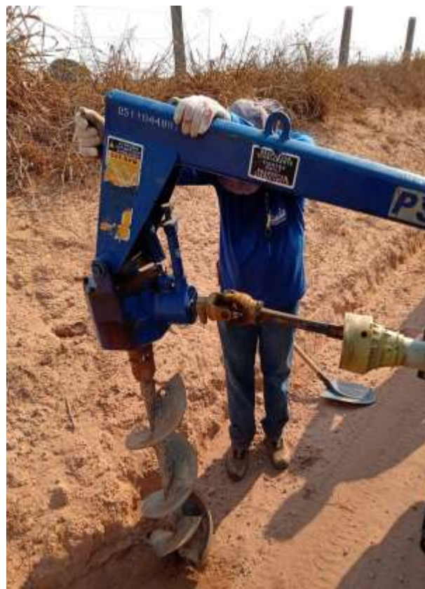
– Sondagem e Coleta de Amostra
