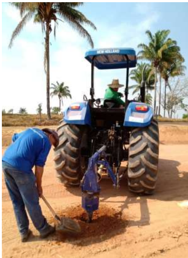
– Sondagem e Coleta de Amostra
