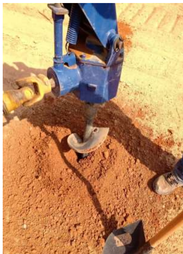
– Sondagem e Coleta de Amostra
